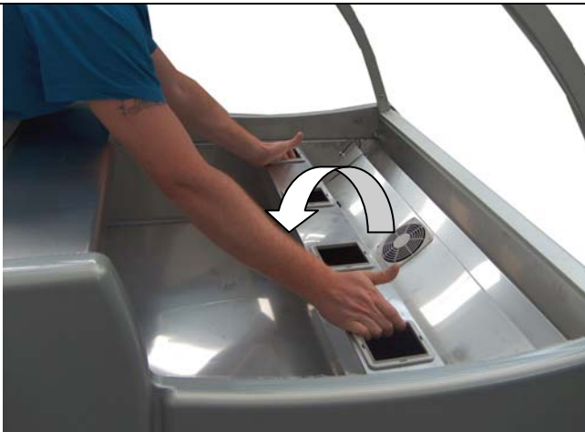
Fig. B: rimozione copri evaporatore
