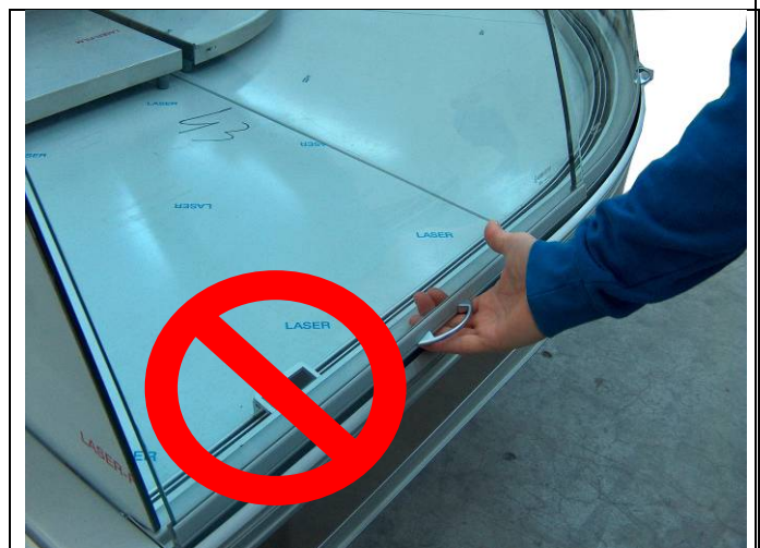
Fig. A: Limb crush hazard
