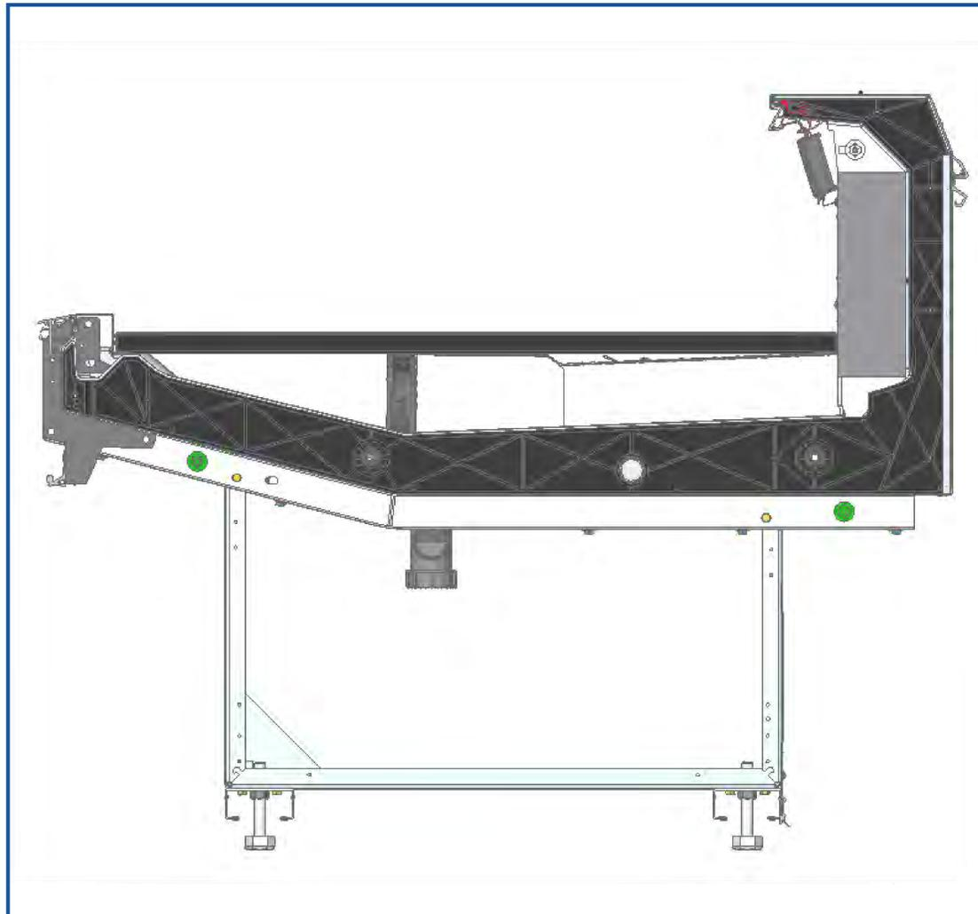
**Unkomplizierte** Montage von Rohrverbindungen, Elektroanschluss und Wasseranschluss dank der großen Öffnung am unteren Thekenrahmen.
