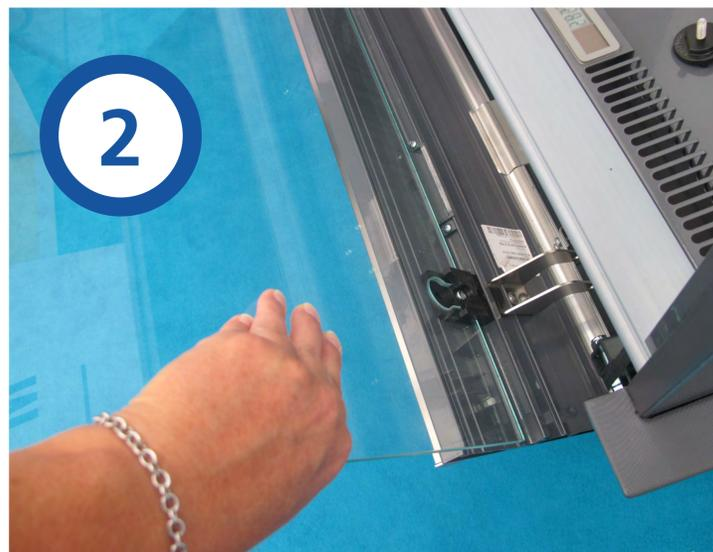
Die nach unten zu öffnenden, geraden oder gebogenen Glasscheiben lassen sich leicht entfernen, um ausgetauscht oder gründlich gereinigt zu werden.
