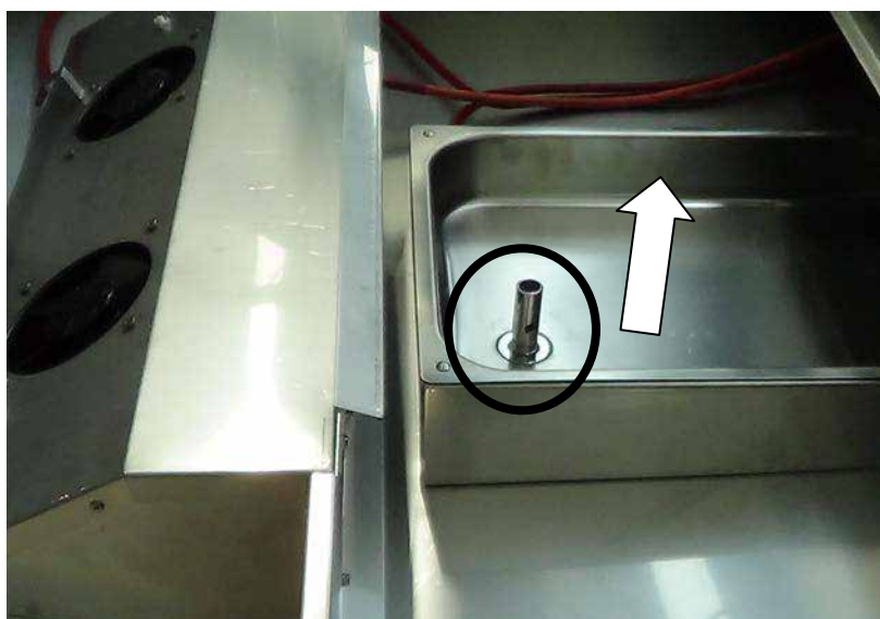
Fig. 19 Bac d'évaporation et tuyau de trop plein
