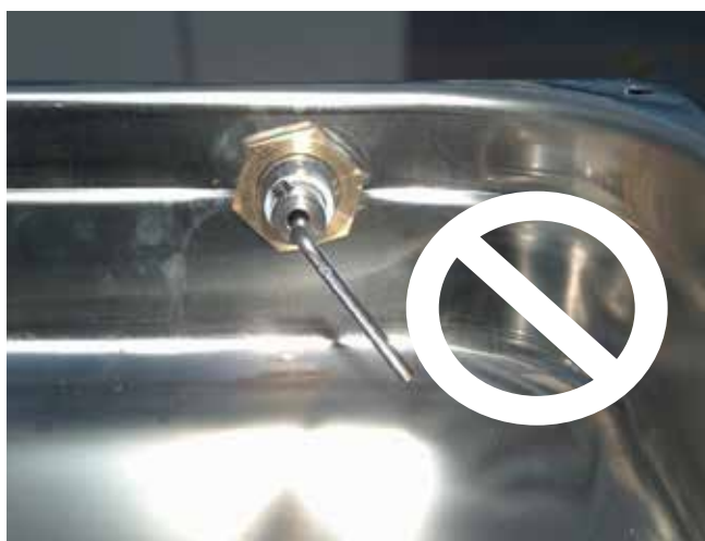
Fig. 21 détail jauge ; position de montage ERRONÉE.
